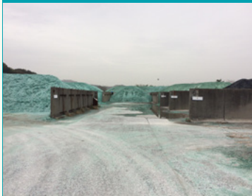
フロートガラス生産のために屋外に貯蔵されている色分けされたカレット
