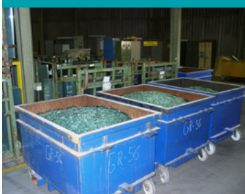
加工工程での自動車用グリーンガラスの内部回収
